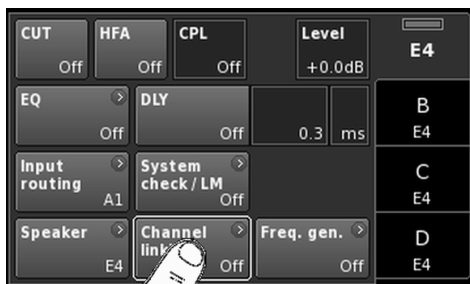
Channel linking example: EQ A ⇒ B; EQ and Delay C ⇒ D
