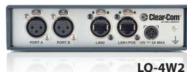
La connectique 2 fils est en XLR, la connectique 4 fils en connecteurs RJ45 Ethercon verrouillables.
