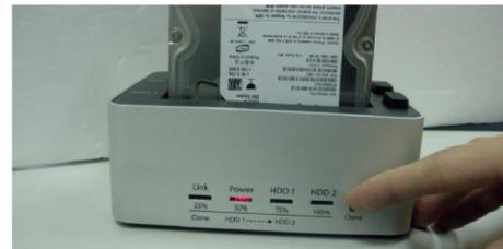
Étape 4 : Les 4 LEDs s'allument l'une après l'autre en orange pour indiquer la progression du clonage. Chaque LED orange correspond à 25% du processus de clonage. La LED reste allumée jusqu'à ce que 25% du disque dur 1 soit cloné vers le disque dur 2 ; la LED suivante s'allume ensuite à son tour. Lorsque l'opération de clonage est complètement terminée, toutes les LEDs clignotent en orange jusqu'à ce que l'appareil ait redémarré.
