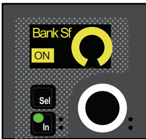
Bank Safe parameter on a CKM encoder
