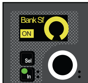
Bank Safe parameter on a CKM encoder
