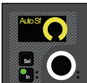
Automation Safe parameter on a CKM encoder
