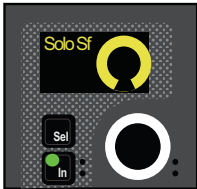
Automation Safe parameter on a CKM encoder
