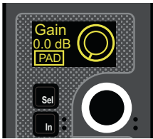
Encoder display showing parameter and parameter value
