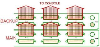
FAILOVER WIRING USING BALANCED BLACKBOX UNITS
