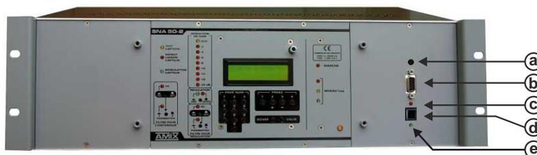
**a -** Switch fugitif permettant d'afficher le numéro de série et d'effectuer le test de l'atténuation des VCA.
