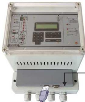
*Switch fugitif permettant d'afficher le numéro de série et d'effectuer le test de l'atténuation des VCA.*
